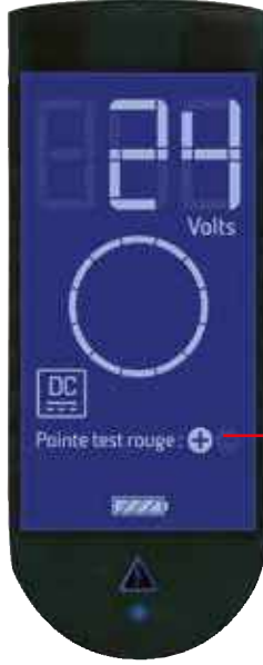
24 V sürekli gerilim tespit örneği, BLUE ekran car < 50 V.
