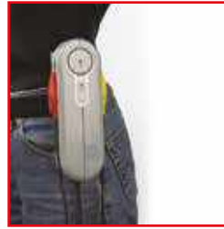
DT-500, temas noktalarını yerleştirmek için entegre edilmiş bir kayış geçişi ve klipsli alanlarla donatılmıştır.
